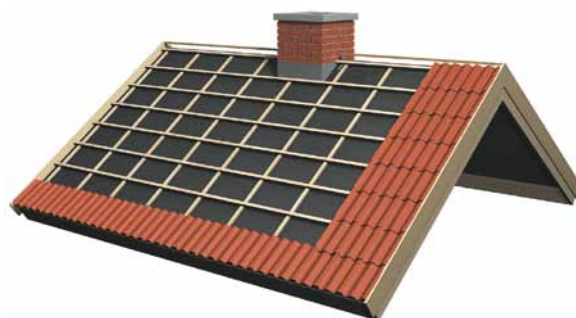
Bild 8. Fortsätt med två till tre rader i taget ända upp. Kontrollera att raderna ligger rakt.
